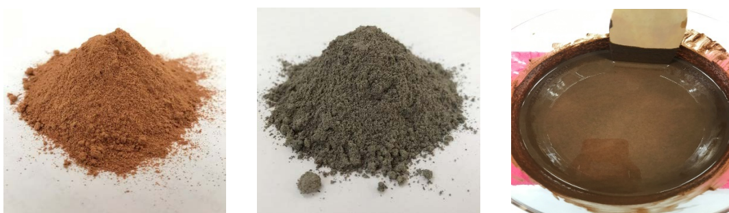
ภาพที่ 23 วัสดุที่ผ่านตะแกรงร่อน ขนาด 325 และจีโอพอลิเมอร์ที่กวนเป็นเนื้อเดียวกัน
